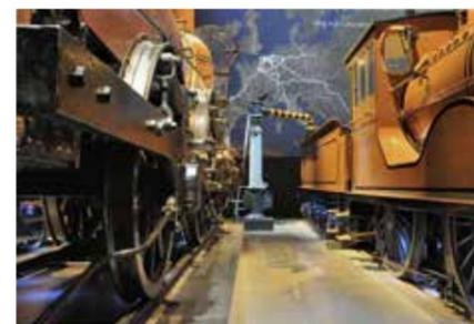
La colonne hydraulique permet de remplir les soutes à eau des locomotives à vapeur.
